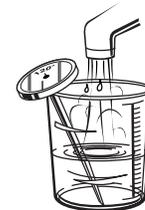
3. Vérifier la température sur le thermomètre pendant que l'eau coule dans la tasse.
